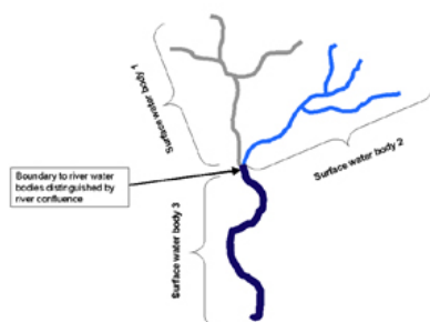
Figur 2 fra Guidance no. 2. Eksempel på opdeling af en flod på grundlag af fysiske egenskaber - i dette tilfælde et vandløbssammenløb
